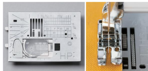
左側の送り歯のみを使用し、より安定した直線縫いを実現。針落ち穴が小さいので、布落ちしにくく薄地縫いも快適です。※プロフェッショナル直線押さえ・プロフェッショナル上送り押さえとあわせて使用します。
