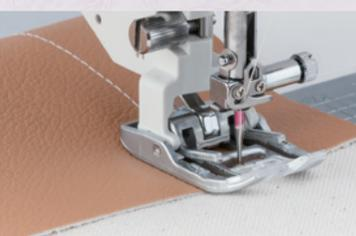
縫い始めにセンサーが布地の厚さを感じ、押さえ圧を自動で調節します。布の厚みが変わる段階縫いなども、再度スタートすることでキレイに仕上がります。
