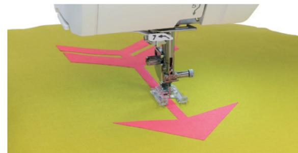
ピボット機能をONにすると、停止時に押さえが自動で上がるので、曲線や角など少しずつ止めながら向きを変えて縫うのにとても便利です。
