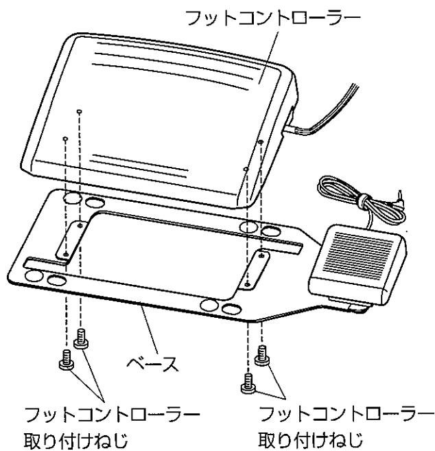
図のようにフットコントローラー取り付けねじ（4個）でフットコントローラーをベースに取り付けます。
