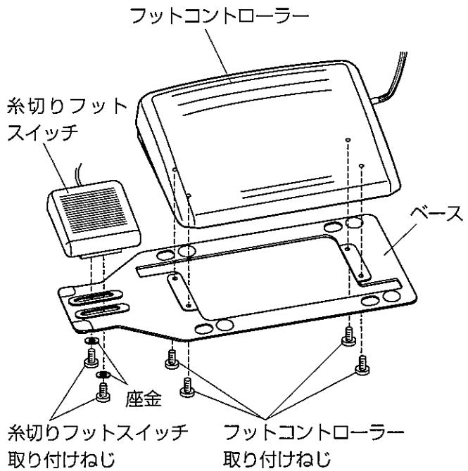
※ フットコントローラー取り付けねじ（4個）と糸切りフットスイッチ取り付けねじ（2個）と座金（2個）を外し、フットコントローラーと糸切りフットスイッチを外します。
