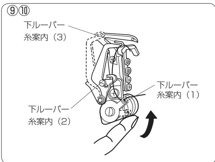
⑨ はずみ車を回して下ルーパーを最右点にして下ルーパー糸案内 (1) を持ち上げると、下ルーパー糸案内 (2)、(3) が、上方に現われます。
