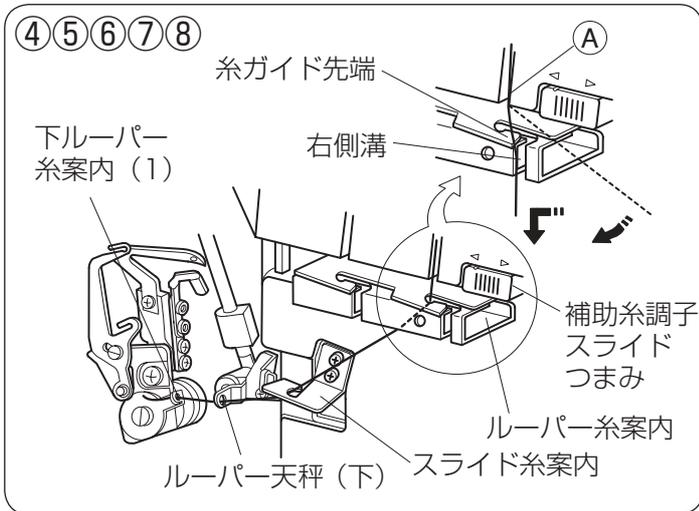
④⑤糸を正面カバーの角部④、糸ガイド先端の順に案内し、ルーパー糸案内の右側溝に通します。
