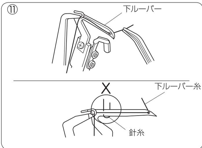
⑪ はずみ車を回して、再び下ルーパーを最右点にします。下ルーパー糸穴に糸を通し、糸端は、糸穴から 10cm ほど引き出しておきます。
