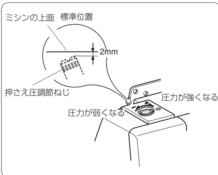
このミシンは、通常、押さえ圧を調節する必要ありませんが、極薄もの、極厚ものとき押さえ圧調節ねじで調節してください。
