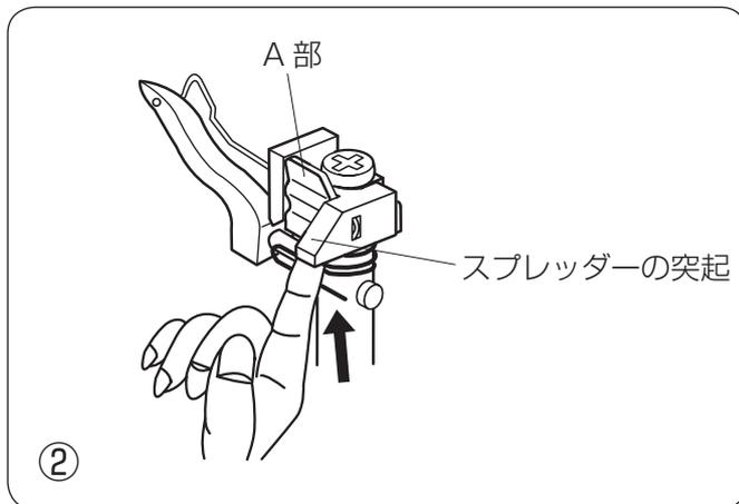
② ホルダーのばね A 部を、手前に軽く引きながらスプレッターの突起を押し上げて抜き取ります。
