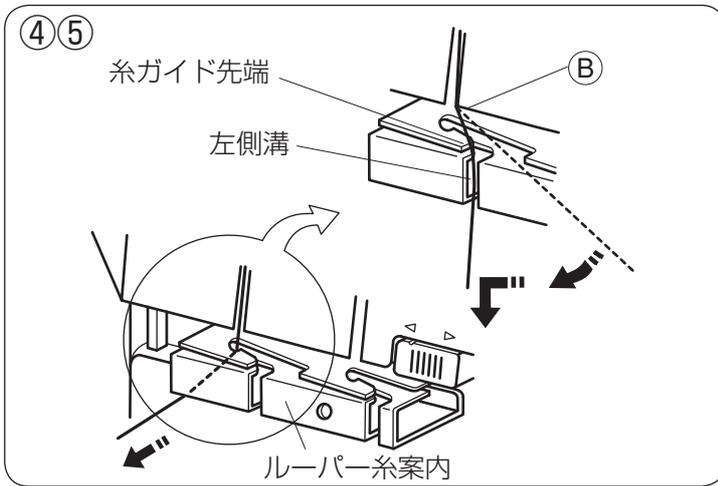
④⑤ 糸を正面カバーの角部 ②、糸ガイド先端の順に案内し、ルーパー糸案内の左側溝に通します。
