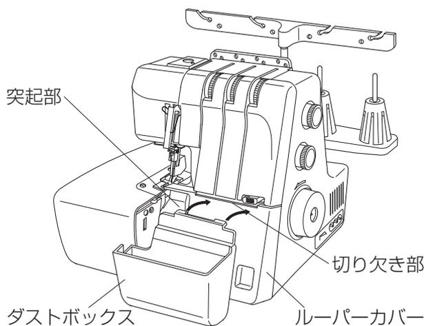
ルーパーカバーの切り欠き部にダストボックスの突起部を差し込み、布くず受けとして使用します。
