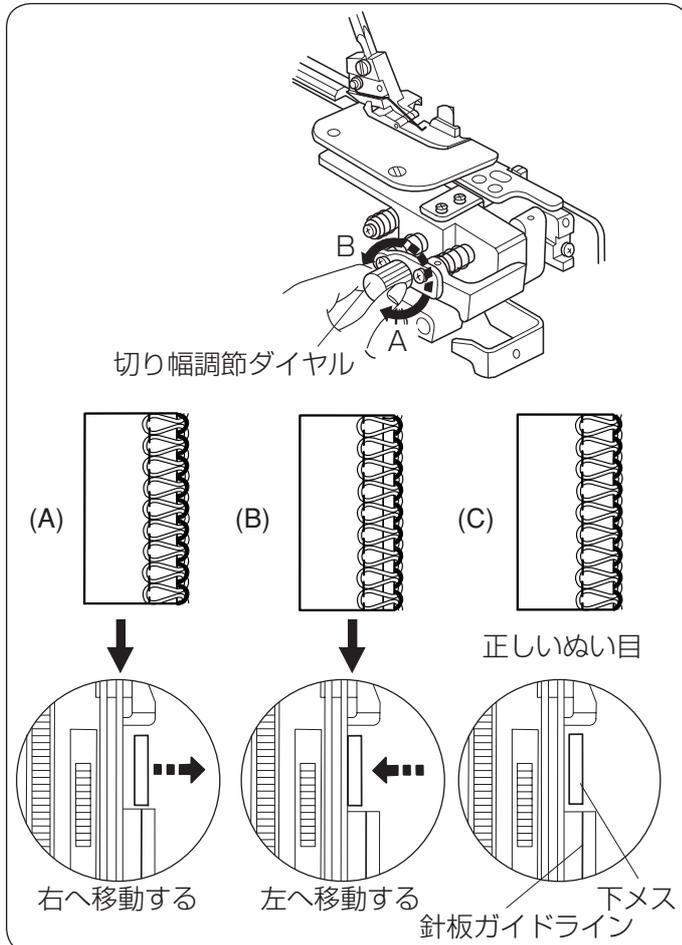
布ふちとぬい目が合っていないときは、切り幅を調節します。きれいにあわないときは糸調子を調節します。切り幅の調節は次のように操作します。
