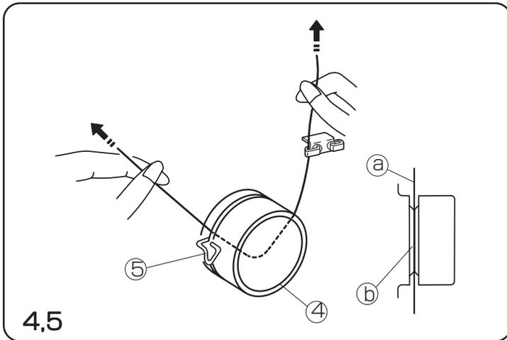
4. 右手で糸を押さえて、左手で糸の先端を引き、上ルーパー糸調子器の糸調子皿の間に入れます。
