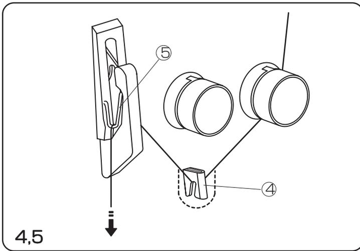
4. はずみ車を回して針を最上部にあげ、糸を針糸掛けに掛けます。
