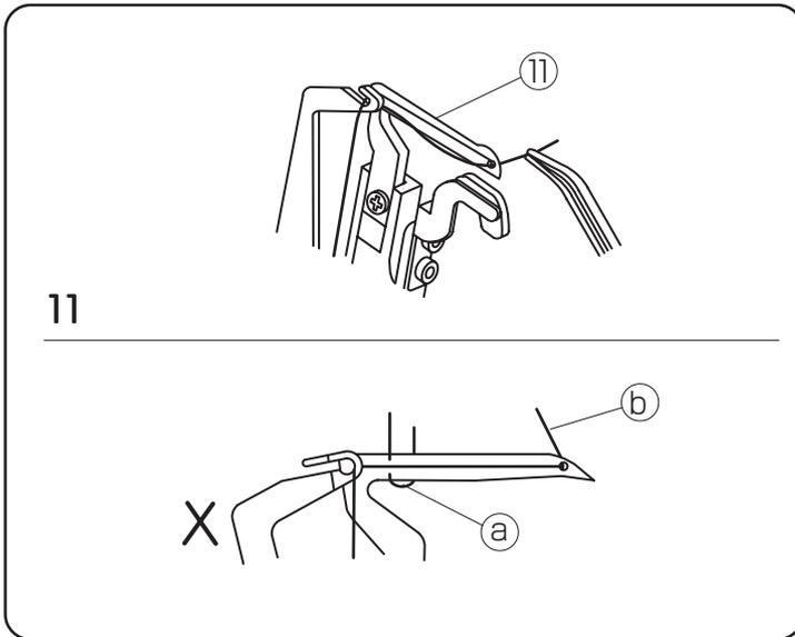
11. はずみ車を回して、再び下ルーパーを最右点にします。下ルーパー糸穴に糸を通し、糸端は、糸穴から10cmほど引き出しておきます。
