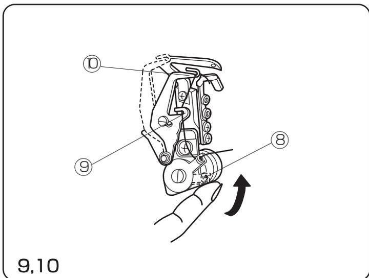
9. はずみ車を回して、下ルーパーを最右点にして下ルーパー糸案内(3)を持ち上げると、下ルーパー糸案内(4),(5)が上方に現われます。
