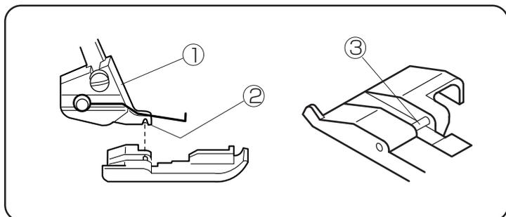
押さえのピンを押さえホルダーのみぞの真下において、押さえ上げを下げれば自動的にセットされます。
