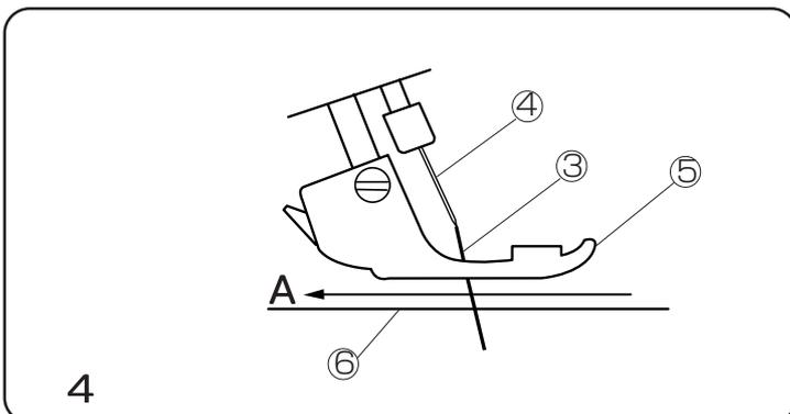
4. 押さえの下の針糸を後ろに払って、針糸を針板の上に出し、押さえの後ろへ10cmほど各を引き出しておけば、糸通しは終了です。(A方向に針糸を払います。)
