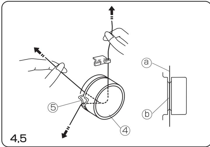
4. 右手で糸を押さえて、左手で糸の先端を引き、下ルーパー糸調子器の糸調子皿の間に入れます。
