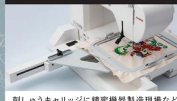
刺しゅうキャリッジに精密機器製造現場などで活躍する産業用ロボット\*1と同じ部品\*2を使用しています。ブレなく正確な位置に針を落とすことができ、緻密で美しい刺しゅうに仕上がります。
