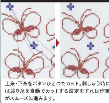
上糸・下糸をボタンひとつでカット。刺しゅう時には渡り糸を自動でカットする設定をすれば作業がスムーズに進みます。
