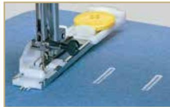
ボタンホール押さえにボタンをセットし専用のステッチを選択すれば、ワンステップでボタンホールをぬうことができます。
