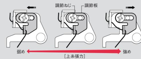
厚物専用の上糸張力を調整できるガイドです。上糸の張力が強くなるので下糸をしっかり引き上げることができ、糸締めりが安定します。厚物や皮革を縫う際に縫い目の乱れを防ぐことができます。
