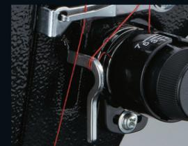
押さえの高さに連動して、糸案内の位置が移動します。布の厚みにあった上糸量が供給され、糸締めりのよいきれいな縫い目を形成します。
