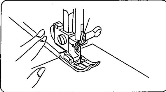
糸と布を左手でおさえ、はずみ車を手前にまわして、ぬい始めの位置に針をさします。押さえ上げをさげて、ぬい始めます。
