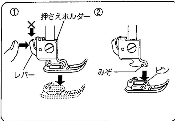
①押さえ上げをあげ、押さえホルダーのレバーを押して、押さえを外します。
