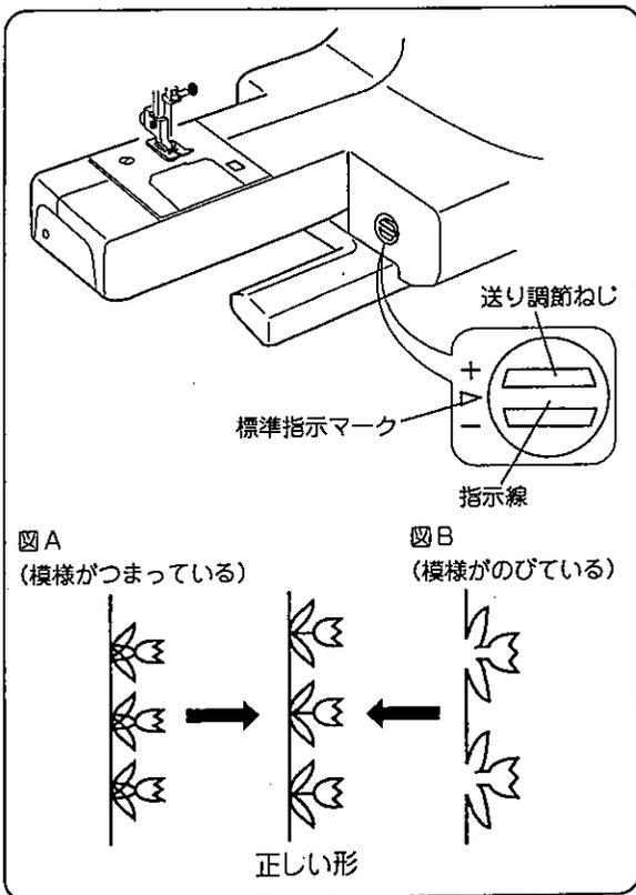
布の種類、厚さ、ぬいの速さなどによっては、模様の形がくずれる場合があります。実際にぬうときと同じ条件で試しぬいをしながら、送り調節ねじで調節してください。
