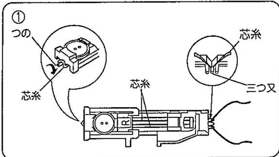
① R オートマチックボタンホール押さえを押さえホルダーにセットして、芯糸の輪を押さえのうしろ側にあるつのにかけ、押さえの下から手前に平行になるように引き出し、前側の三つ又にはさみます。ぬい目の幅は芯糸に合わせてセットします。
