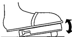
フットコントローラーを踏むと、ミシンがスタートし、速度も調節できます。
