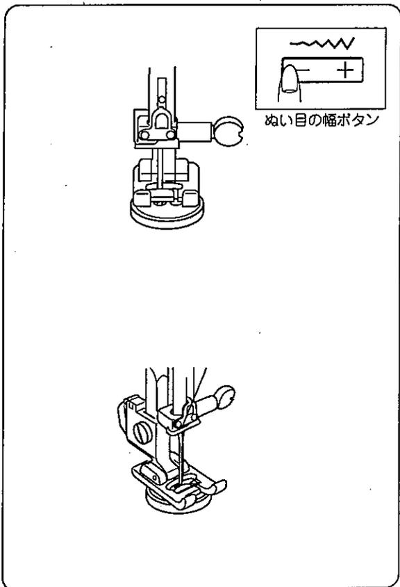
① 針に糸を通さない状態で押さえの下にボタンを置き、はずみ車をまわして、ぬい目の幅がボタン穴の間かくと同じになるように、ぬい目の幅ボタンで調節しておきます。
