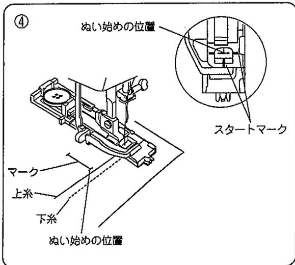
④ 押さえ上げをあげて上糸を押さえの穴から下に通し、横に引き出して下糸とそろえます。布を入れ、押さえのスタートマークとぬい始めの位置を合わせ、はずみ車を手でまわし、針をさして押さえ上げえをさげます。
