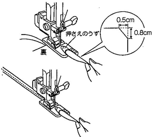
① 布を巻き込みやすくするため角を少し切り、押さえのうずの中に布を針がとどくところまで入れて、針をさして押さえ上げをさげます。
