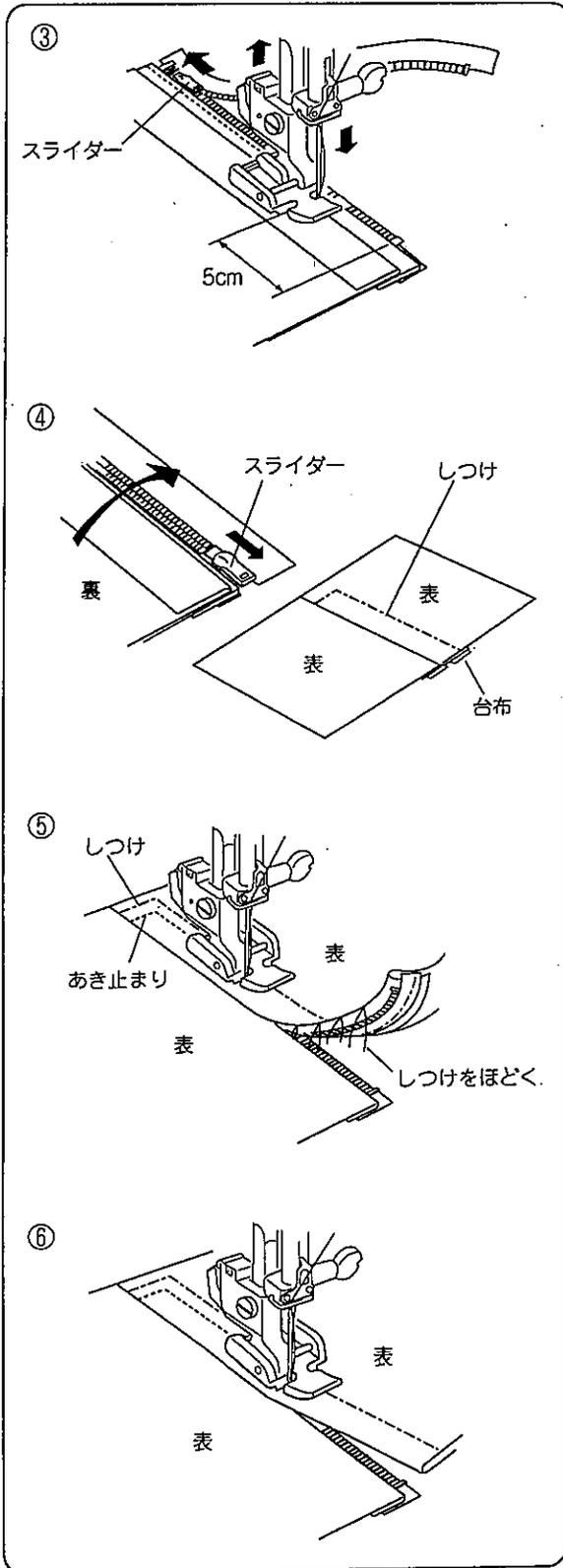
③ ファスナーの端から5cmほど手前でミシンを止め、針を布にさします。押さえ上げをあげてスライダーを押さえの向こう側にずらし、押さえ上げをさげて残りの部分をぬいます。
