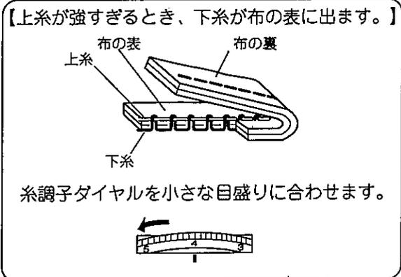
糸や布の種類によって糸調子のバランスがとれないときには、糸調子ダイヤルを「0～9」の範囲に合わせると、マニュアル糸調子となり、上糸と下糸のまじわる位置を自由に調節できます。
