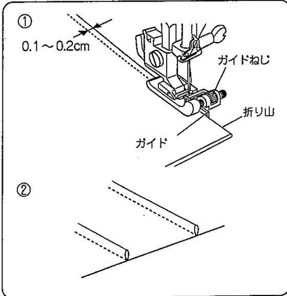
① はずみ車を手前にまわして、針が折り山より0.1～0.2cm内側におりるように布を置いて、押さえ上げをおろします。ガイドねじをまわしガイドを折り山に合わせて、ぬいます。
