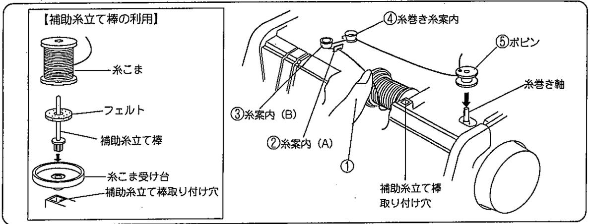
※補助糸立て棒での利用もできます。補助糸立て棒を使うときは、取り付け穴にセットします。糸の端は糸こまの右側からうしろに出るようにします。
