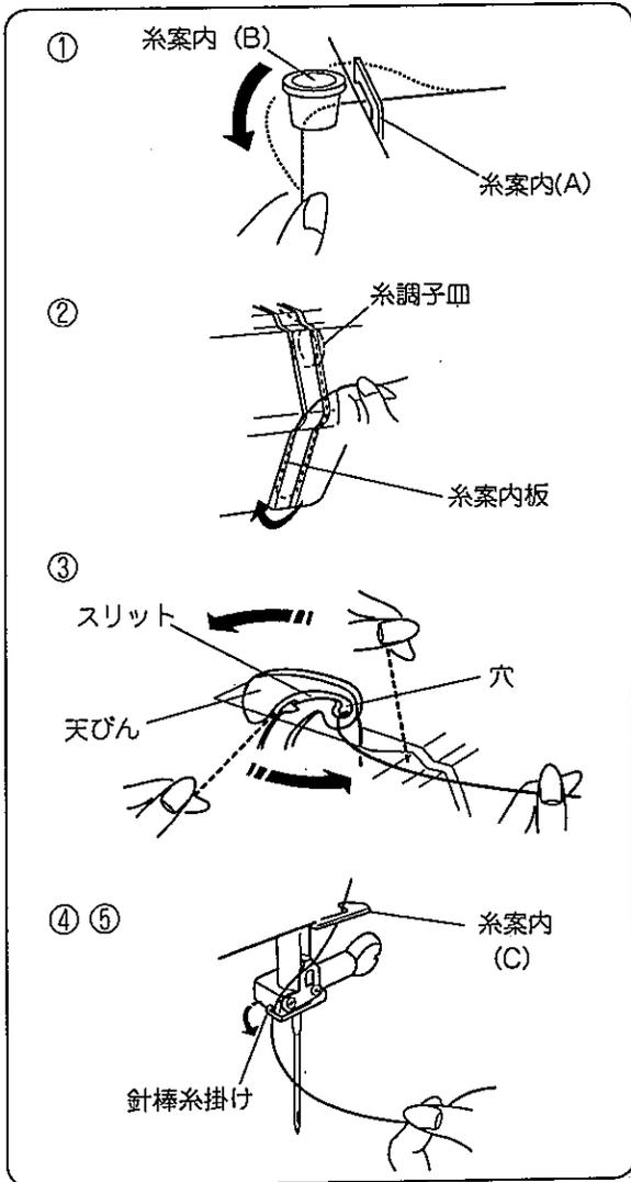
① 押さえ上げをあげた状態で、糸こまから糸を引き出し、右手で糸こま側の糸を押さえます。左手で糸を持ち、糸案内 (A) に通し、糸案内 (B) の下に巻きつけるようにしてかけ、糸案内板にそっておろします。
