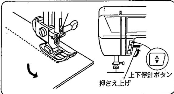
ミシンを止め、上下停針ボタンを押して針を布にさし、押さえ上げをあげます。針を布にさしたまま、ぬい方向をかえます。押さえ上げをさげて、ふたたびぬい始めます。
