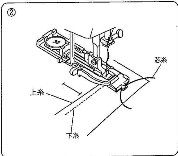
② 上糸と下糸を横に引き出してそろえます。ぬい始めの位置に針をさして押さえ上げをさげます。ミシンをスタートさせて、センサーボタンホールの手順と同じようにぬいます。
