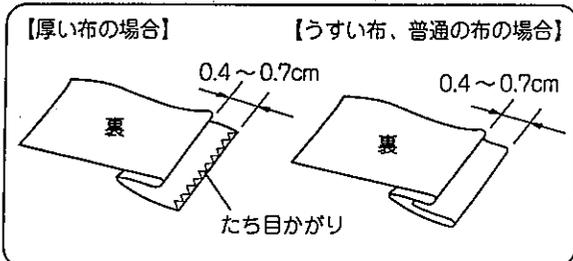
布の裏を上にして、図のように、布端を0.4～0.7cmほど出して折り込みます。
