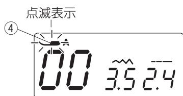
\* 押さえ上げをさげないでミシンをスタートさせた場合、安全装置がはたらきミシンをスタートできません。このとき、画面の押さえ表示④が点滅します。
