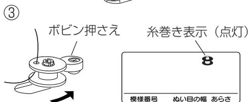
③ ボビンを、ボビン押さえの方に押しつけます。表示画面に糸巻き位置にセットされたことを示す糸巻き表示が点灯します。
