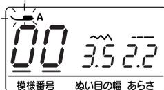
※押さえ上げをさげないでミシンをスタートさせようとするとう安全装置がはたらいミシンがスタートできないようになっています。このとき表示画面の押さえ表示が点滅します。押さえ上げをさげてスタートさせてください。
