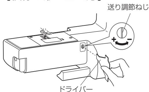
布の種類などによっては、模様の形がかすれる場合もあります。実際にぬうときと同じ条件で試しぬいをしながら、送り調節ねじで調整してください。(補助テーブルを外します。5 ページ参照)
