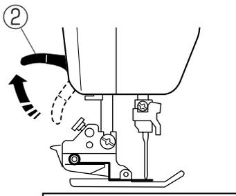
3 押さえ上げをあげ、はずみ車を手で逆方向（矢印方向）に1回転させます。
