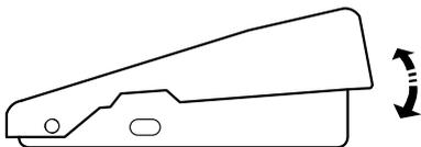
ミシンの速さは、フットコントローラーで調節します。
