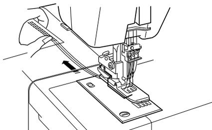
4 布をうしろに引き出し、ルーパー糸を針板の上に引き出して、糸切りで切ります。
