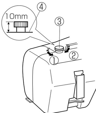
このミシンは、通常、押さえ圧を調節する必要はありませんが(工場出荷時にほとんどの生地に合うように調節されています)、極薄物、極厚物のとき押さえ圧調節ねじで調節してください。
