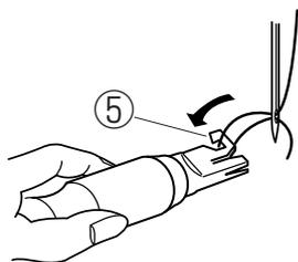
5 後ろに出された糸の輪を、ホルダーのフックにかけ、糸の端を約10cmほど引き出します。
