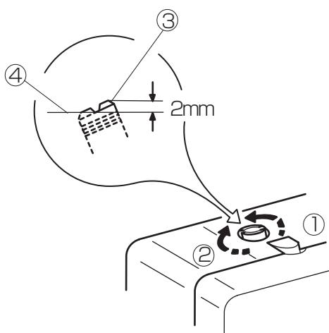
\*このミシンは、通常、押さえ圧を調節する必要はありませんが、極薄もの、極厚もののとき押さえ圧調節ねじで調節してください。
