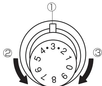
\*針糸、上ルーパー糸、下ルーパー糸の3つの糸調子器は、目盛「3」を基準に試し縫いをして、縫い目を見ながら正しく調節してください。
