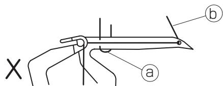
11. はずみ車を回して、再び下ルーパーを最右点にします。下ルーパー糸穴に糸を通し、糸端は、糸穴から10cmほど引き出しておきます。
