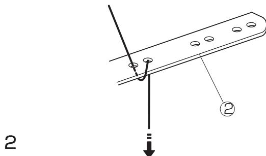
3. 右手で糸を押さえて、左手で糸の先端を引き、針糸調子器の糸調子皿の間に入れます。
