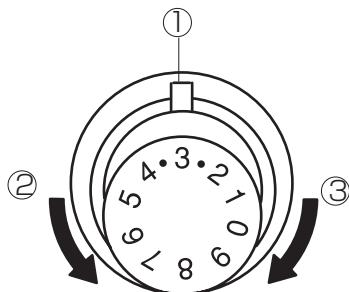
\*左右の針糸、上ルーパー糸、下ルーパー糸の4つの糸調子器は、目盛「3」を基準に試し縫いをして、縫い目を見ながら正しく調節してください。
