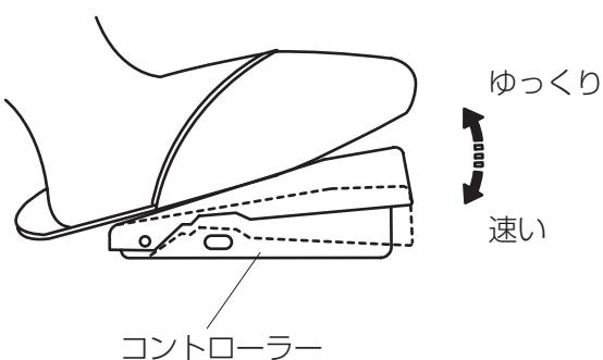
ミシンの速さは、コントローラーで調節します。
