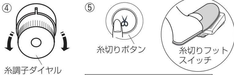
④ ぬい目を確認して、糸調節ダイヤルをまわして、糸調子を調節します。
