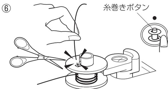
⑥ 糸の端をつまんだまま (図のように上方方向にかくつまんでおきます。) 糸巻きボタンを押します。糸巻きがスタートして、ポビンに糸を約 3 秒間巻きつけたら、糸巻きボタンを押して止めます。穴のすぐ近くで、つまんでいる糸を切ります。
