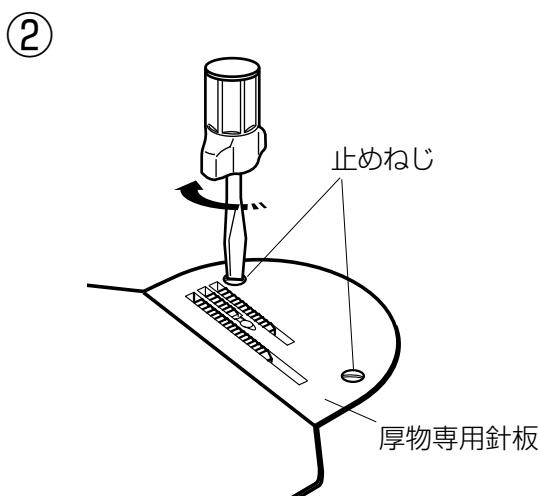
① 止めねじ (2ヶ) を外し、針板 (標準) を外します。
