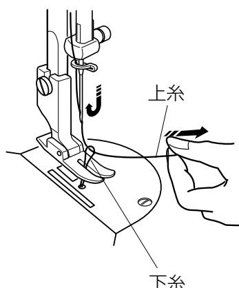
② 電源スイッチを入れて、上下停針ボタンを押し針をさげ、もう1度ボタンを押して針をあげます。上糸を軽く引くと、下糸の輪が引き出されます。
