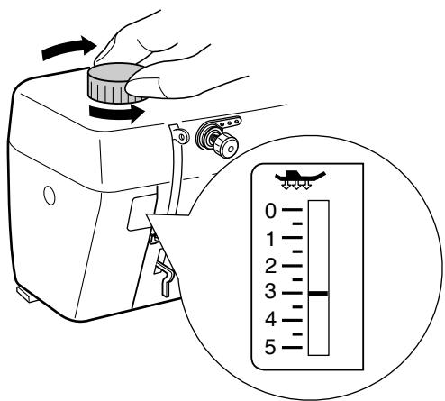
普通の布のときは、押さえ圧調節ダイヤルをまわして、指示線を「3」に合わせます。
