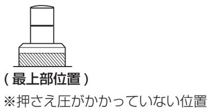
押さえ圧調節ボタンを押して、ぬいに適した押さえ圧に調節します。
