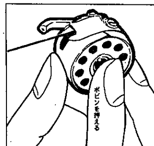
22図 ボビンがぬけないよう押える
