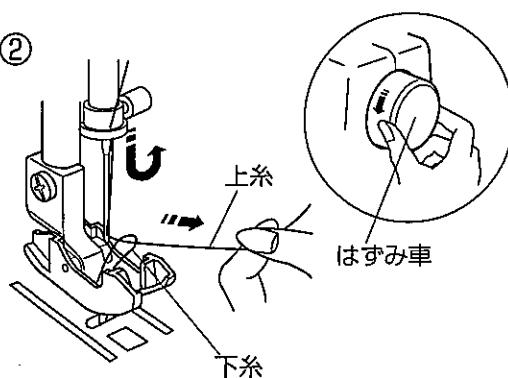
②はずみ車を手前に1回転させ、上糸を軽く引くと、下糸の輪が引き出されます。
