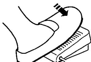
フットスイッチを踏むと、スイッチが入りミシンが回転します。踏み込みをはなすと、スイッチが切れミシンは止まります。
