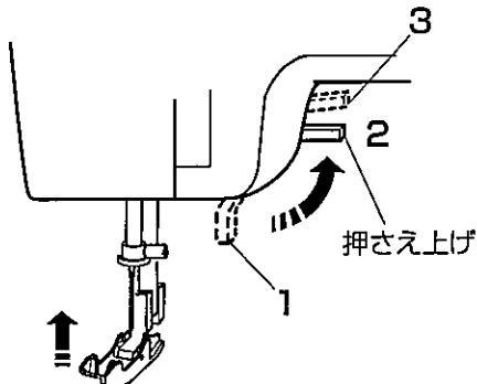
押さえ上げで、押さえの上げ下げを行います。普通に上げた位置よりさらに上げることもでき、厚い布を入れるときの補助リフトとして使用します。
