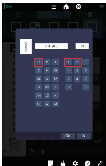
Quando programe una combinación de patrones, oprima Selector rápido de puntada ② para abrir la ventana Selector rápido de puntada para el modo de programación.
