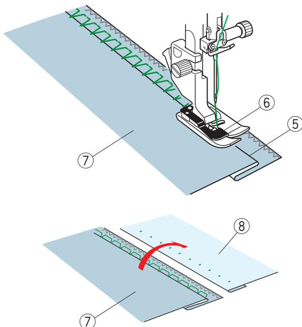
Legen Sie den Stoff so ein, dass der Falz an der linken Seite der Führung des Nähfußes anliegt. Senken Sie den Nähfuß.
