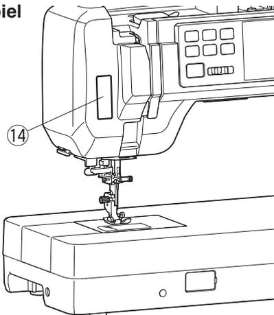
7 Ziehen Sie den Faden fest nach oben zur Rückseite des Fadenhebels, während Sie den Faden an der Nähgarnrolle festhalten. Fädeln Sie ihn dann nach vorne durch das Ohr des Fadenhebels.
