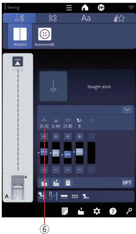
Die eckige Klammer ⑥ zeigt an, dass der benutzerdefinierte Wert auf die Einstellung angewendet wird.
