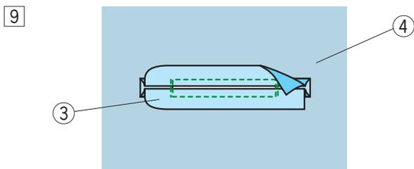
9 Das Stoffstück muss 1 bis 1,5 cm vom Loch entfernt abgeschnitten werden. Die Ecken müssen rund abgeschnitten werden (siehe Abbildung).
