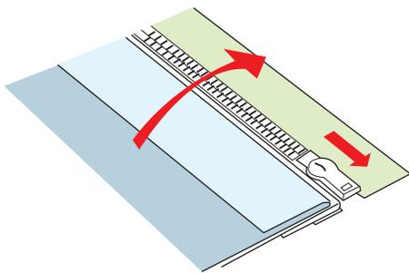
Senken Sie den Fuß auf die Oberseite am unteren Ende des Reißverschlusses, so dass die Nadel den Stoff neben der Falte und dem Reißverschlussband durchsticht.
