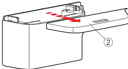
Um die Abdeckung des Zubehörfaches zu öffnen, schieben Sie die Abdeckung des Stauraums zu sich hin.
