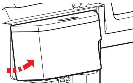
Sie können das Zubehörfach entfernen. Zum Entfernen ziehen Sie die Unterseite wie abgebildet heraus.
