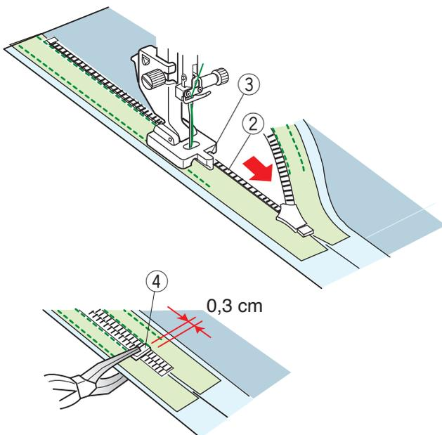
Heben Sie die Reißverschlusszähne links an und senken Sie den Fuß, so dass durch die rechte Nut des Nähfußes die Reißverschlusszähne laufen.
