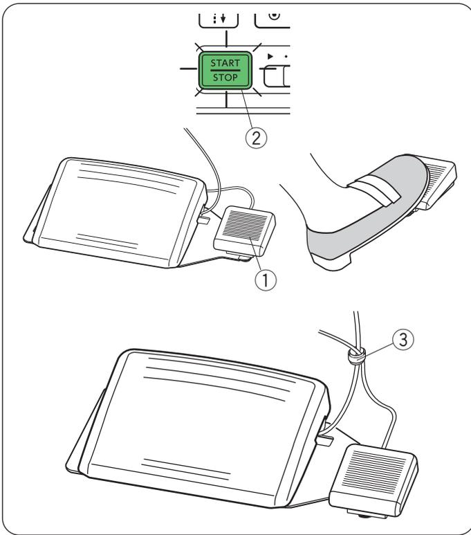
Treten sie nach dem Nähen auf das Fadenschneiderpedal ① auf der rechten Seite des Fußanlassers, um den Ober- und Unterfaden zusammen abzuschneiden.
