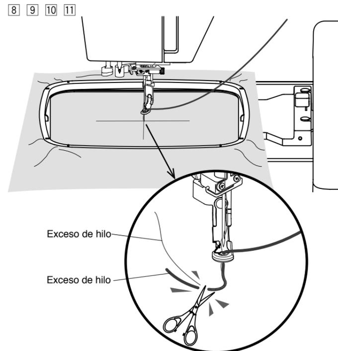
8 Coloque la tela unida con el estabilizador en el bastidor.
