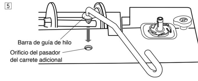
5 Inserte la barra de guía de hilo en el orificio del pasador del carrete adicional.
